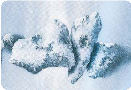
Grain de Filter-Ag (silicate d'alumine non hydraté)
