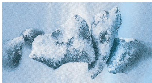
Grain de Filter-Ag (silicate d'alumine non hydraté)
